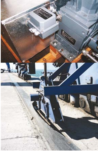
Typ INH użyty w sterowaniu bębna kablowego
